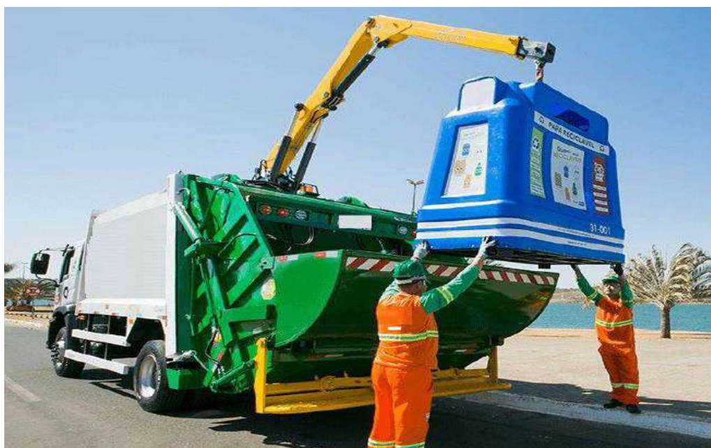
Figura 10: Sistema adotado para a coleta nos Pontos de Entrega Voluntária (PEVs)
